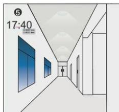
La luz se enciende automáticamente al 10% cuando la luz natural es insuficiente. (sin detectar movimiento).
