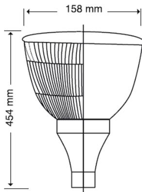
Luminaria tipo punta de poste tecnología LED. Cuerpo de aluminio puro inyectado a presión, recubierta con pintura tipo poliéster aplicada electrostáticamente lo que le brinda mayor resistencia a la corrosión. Refractor de acrílico con prismas. Reflector en forma de tapa de lámina de aluminio anodizado. Sistema EcoLED marca Epistar con óptica y curva de distribución integrada. Driver marca Done. Supresor de picos de 10kV. Garantía de 5 años
